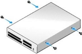
3. Alinhe os parafusos laterais da unidade de disquete com as respectivas aberturas e empurre-a delicadamente para dentro do compartimento até que ela se encaixe no lugar.
